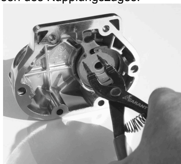
Zu Punkt 5 Kupplungs-Segment einsetzen.
