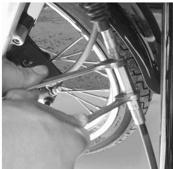
Zu Punkt 2 Lösen des Kupplungszuges.
