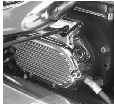
Zu Punkt 4 Getriebedeckel entfernen
